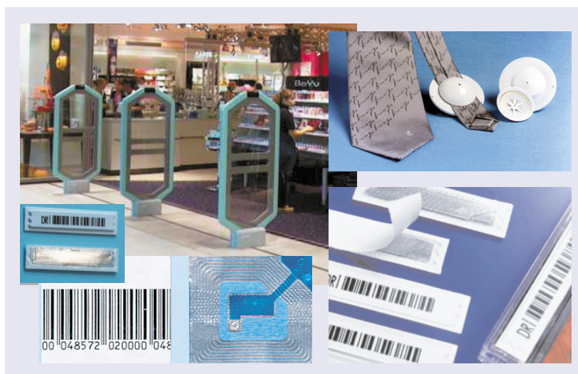
Abb. 1: Zur Diebstahlsicherung werden Sicherungsetiketten an der Ware befestigt, die sich in Schleusen am Ladenausgang detektieren lassen. Obwohl die Etiketten ganz verschieden aussehen können, gibt es vom Prinzip her nur drei verschiedene Warensicherungssysteme: das Radiofrequenz-, das elektromagnetische und das akustomagnetische System.
